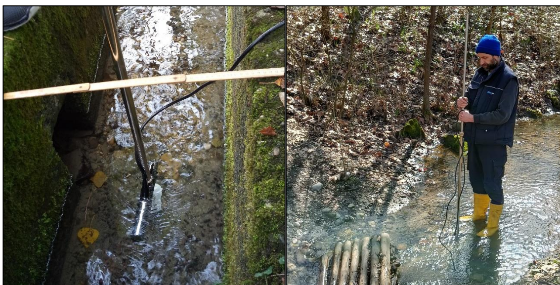
Figura 5 – Misure di portata effettuate a Cartigliano: canale di ingresso a sinistra e di uscita a destra
