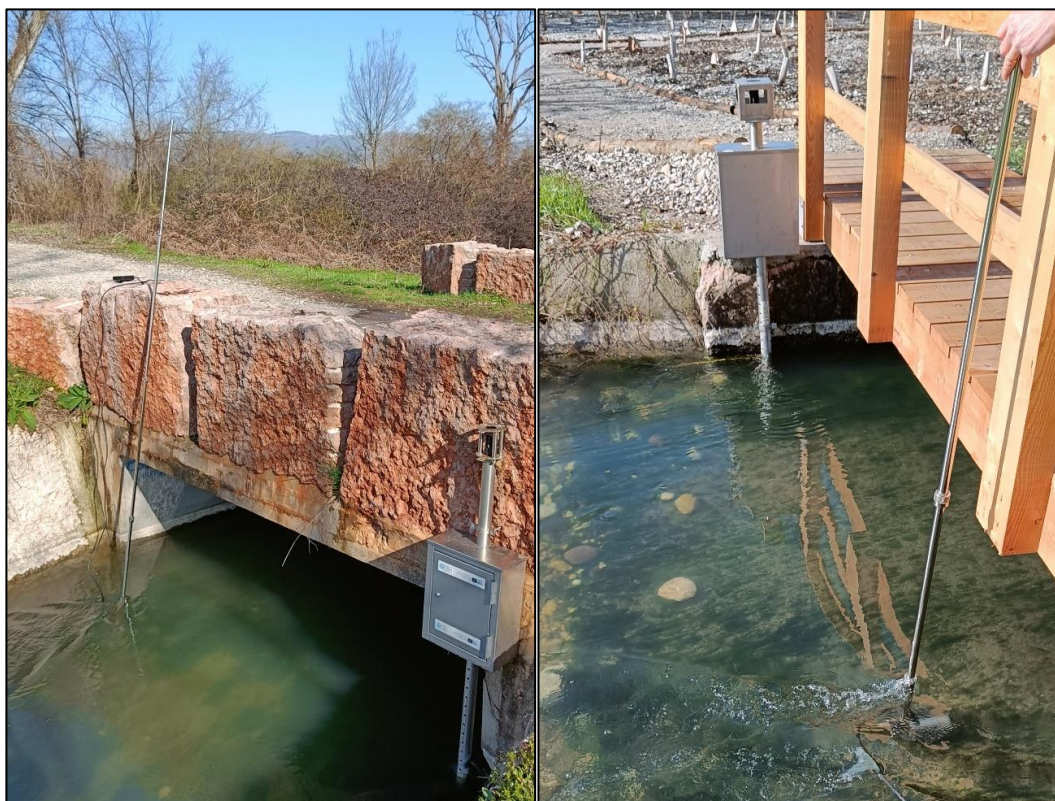
Figura 2 – Misure di portata effettuate a Tezze sul Brenta: sezione di ingresso a sinistra, di uscita a destra; nelle fotografie sono visibili i 2 idrometri per la registrazione del livello idrometrico
